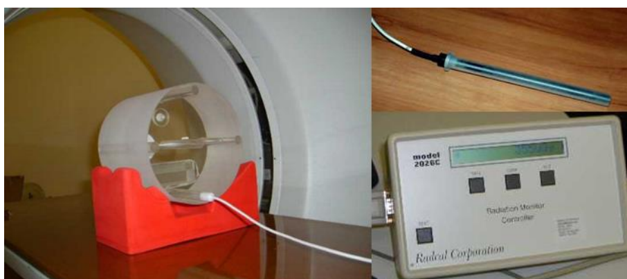
Figure 2 : Fantôme de dosimétrie en PMMA avec la chambre d'ionisation dite « crayon » positionnée dans le fantôme, chambre d'ionisation et électromètre associé.
